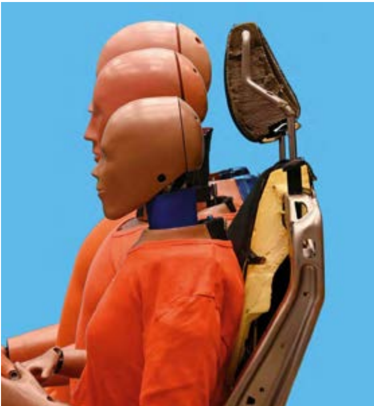
Aufgeschnittener Fahrzeugsitz mit stützender Struktur nur für den Kopfschwerpunkt 50%-Mann
