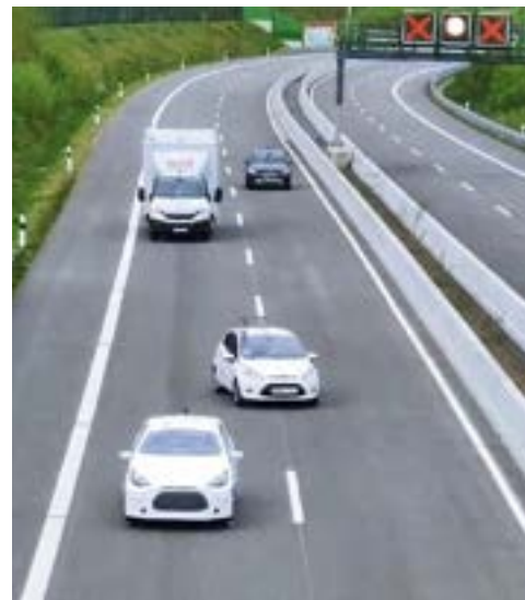
Szenario: liegen gebliebenes Pannenfahrzeug (vorne als crashbares Pkw-Target), dahinter ausschender Pkw vor Testfahrzeug (Lkw), daneben ein Fahrzeug (schwarz), das einen Spurwechsel verhindern soll
